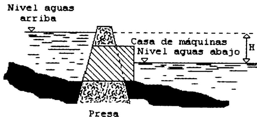
Figura 2.3. Esquema de una central de agua fluente.
