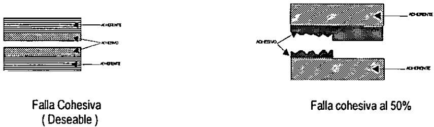
Fig. 1.2-4 Representación de falla cohesiva
