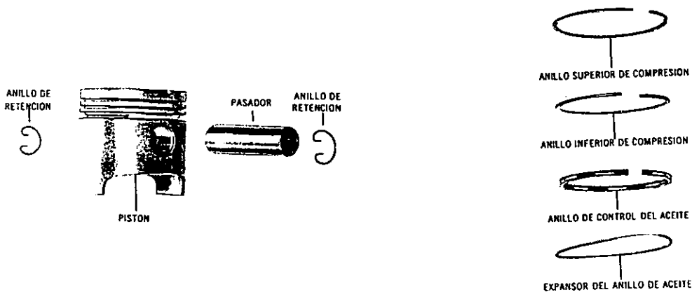
Figura 3.5 Componentes del pistón y sus anillos
