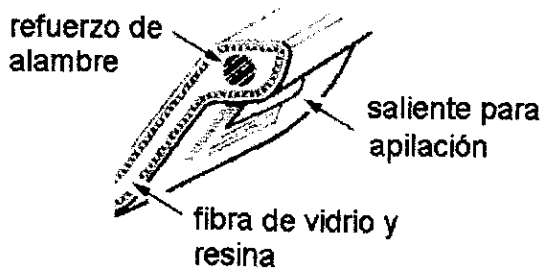
figura no. 1 Corte transversal
