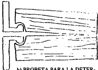
b) PROBETA PARA LA DETERMINACION DE LA RESISTENCIA A LA HENDIDURA
