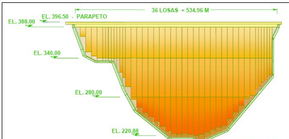
Fig. III. 2. Etapas de colado de la cara de concreto.
