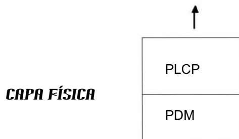
Figura 26. División de la capa física PHY en dos subcapas
