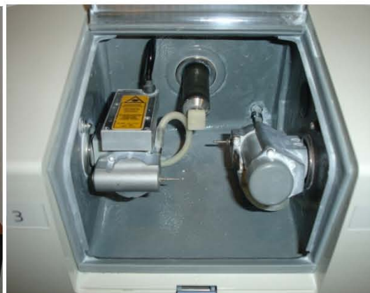
Fig. 6. Motores talladores con fresas de diamante cilíndricas
