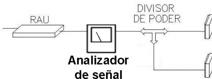
Figura V.18. Medición de potencia a la salida de la RAU.
