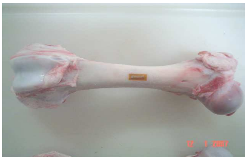
Figura 3.8: Extensómetro adherido sobre diáfisis femoral
