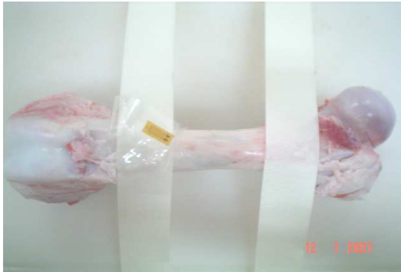
Figura 3.7: Procedimiento de adhesión de extensómetro sobre diáfisis femoral
