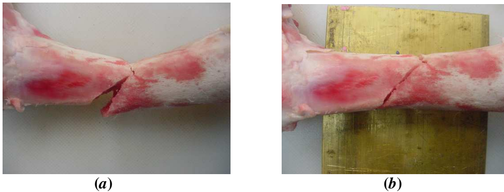
Figura 2.6 a y 2.6 b: Fracturas en diáfisis de fémur porcino sometido a flexión en tres puntos.
