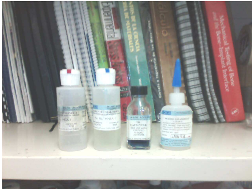
Figura 3.10: Aditamentos para preparación de superficie y adherencia de extensómetros eléctricos: acondicionador, neutralizador, catalizador y pegamento
