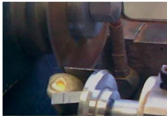
Fig. 22 Corte con disco de carburo de la muestra enucleada en resina (Laboratorio de Preparación de Muestras, IFUNAM) (Fuente directa)
