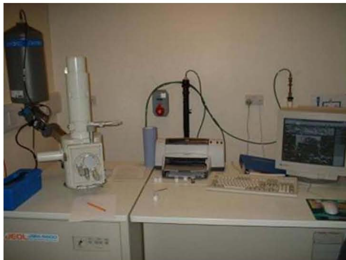
Fig.19 Microscópico electrónico de barrido JEOL JSM 5600LV Laboratorio Central de Microscopia IFUNAM. (Fuente directa)
