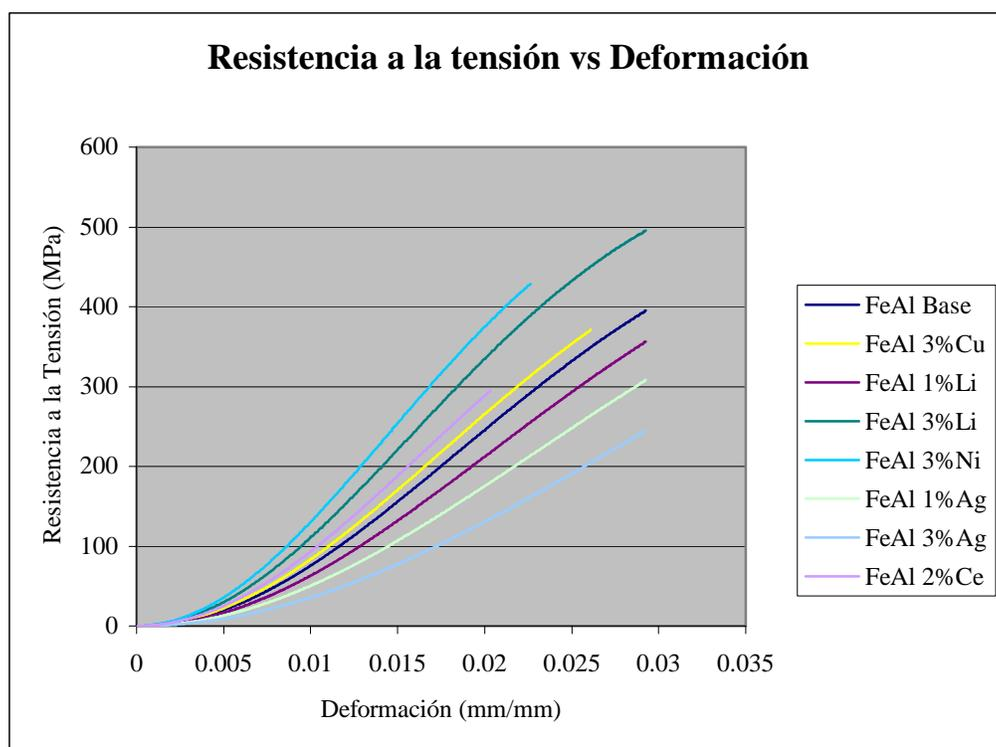
Fig. 4.1 Grafica Deformación vs Resistencia a la Tensión obtenida para las aleaciones
