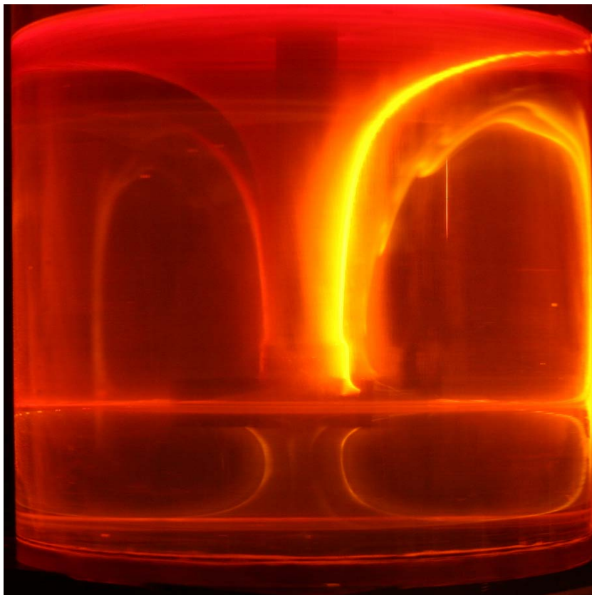
Fig. 19 Patrones de flujo a condiciones excéntricas (agitador descentrado 5mm) mediante LIF
