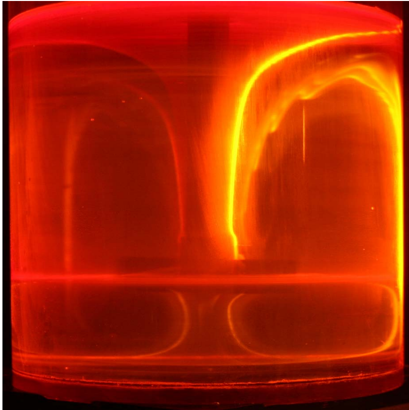
Fig. 18. Patrones de flujo a condiciones centradas mediante LIF
