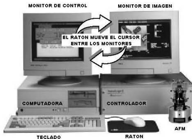
Figura 22. Partes que componen el Microscopio de Fuerza Atómica.
