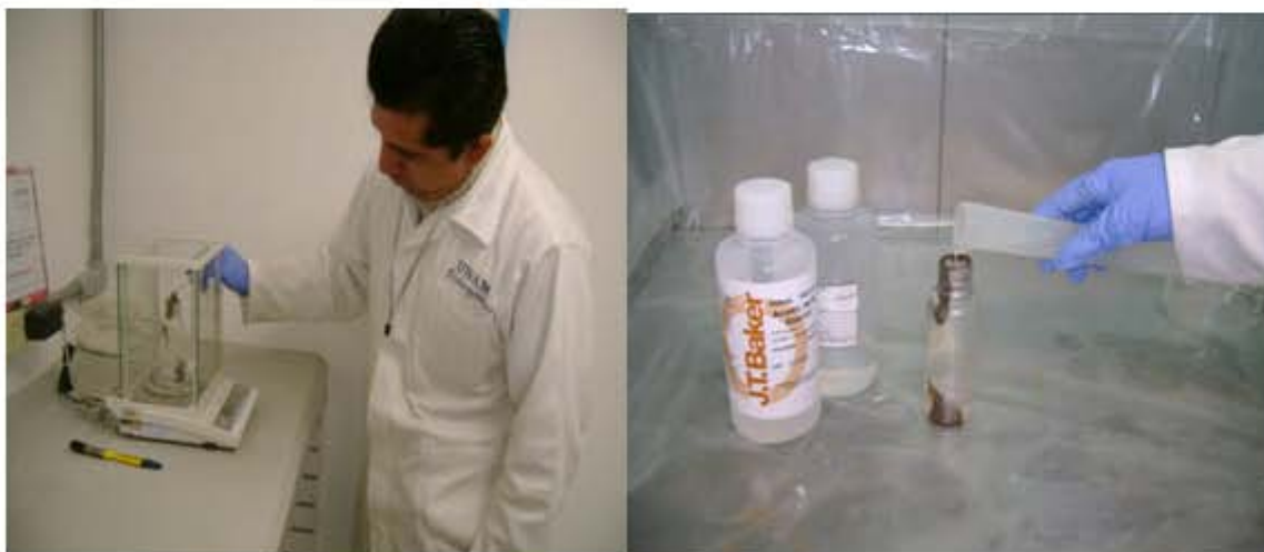
Figura 6-2. Pesado de muestras y agregado de ácido acético glacial.
