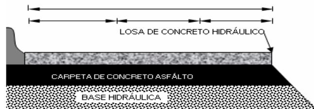
Fig. 13. Pavimentos rehabilitado con carpeta de concreto hidráulico
