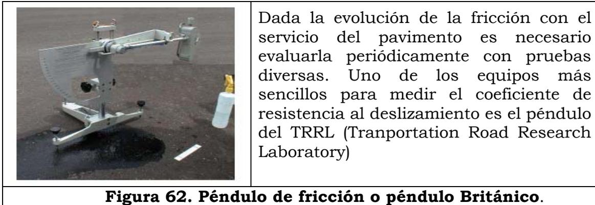
Entre las diversas formas de medir la fricción en pavimentos, destaca su medición empleando una correlación con el coeficiente de fricción físico; Con la prueba se puede determinar la resistencia al deslizamiento y en general consiste en medir la pérdida de energía del péndulo cuyas características corresponde a ciertas especificaciones; esta provisto en su extremo de una zapata de caucho. La pérdida de energía se mide por el ángulo suplementario de la oscilación del péndulo. (Ver capítulo II.1)
