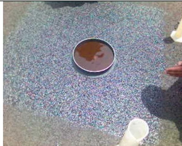
Pruebas de permeabilidad para definir la razón del riego de taponamiento para impermeabilizar la microcarpeta
