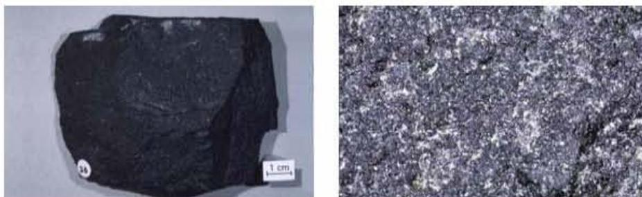
Fotografía No. 32a y 32b. Basalto con Microfenocristales de augita
