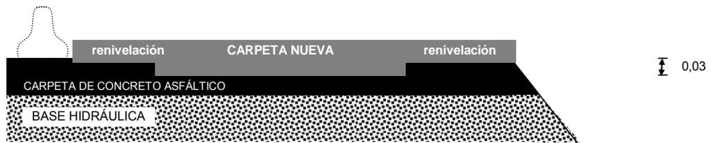
4,- Riego de liga para adherencia de la sobrecarpeta de 3 cm de espesor
