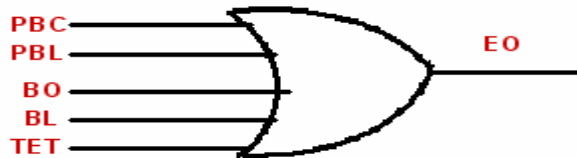
Figura 10 Diagrama lógico de notificación para el sistema.
