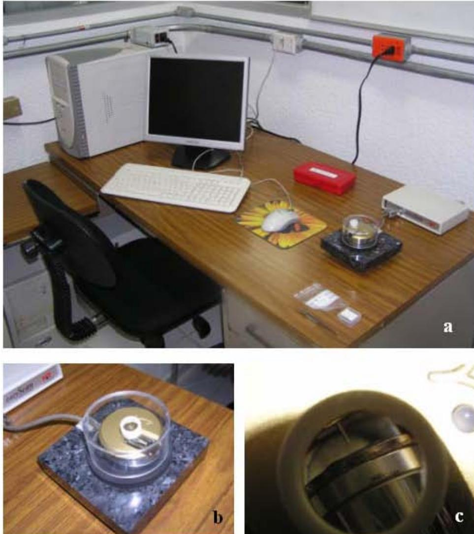
Figura 17. (a) Equipo completo de Nanosurf EasyScan E-STM versión 2.1. (b) Acercamiento a la cabeza para barrido, situada sobre la plataforma antivibratoria. (c) Parte del equipo en que se ubica el portamuestras y la punta para barrido, y ocurre el análisis de la superficie (visto a través del lente de 10 ×).
