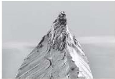
Figura 12. Se muestra cómo debe ser la terminación de la punta de Pt/Ir para lograr la mejor resolución posible. (Tomado de: EasyScan E-STM, 2004).
