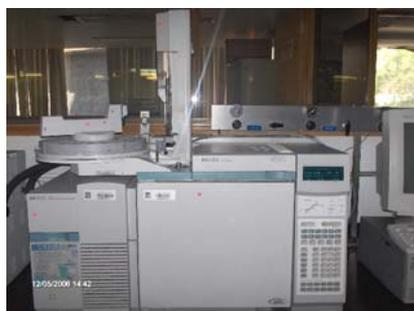
FIG. 23-Cromatógrafo de Gases / Espectrómetro de Masas (GC-MS)
