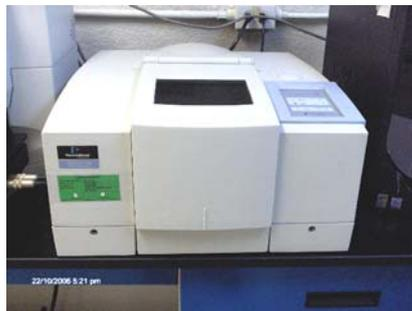
FIG. 13-Espectrofotómetro de luz infrarroja (I:R)
