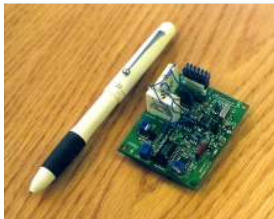
Figura 1.9 Brújula electrónica Ez-compass-3 que incluye un magnetómetro en tres ejes y dos inclinómetros.
