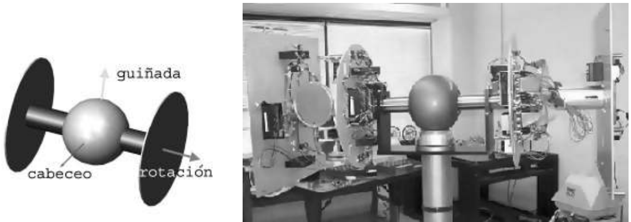
Figura 1.20 Plataforma tipo dumbbell , que permite el movimiento libre en dos ejes.
