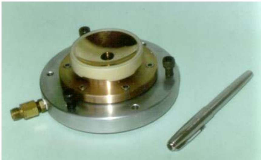
Figura 5.12. Copa con la brida para suministro de aire a presión
