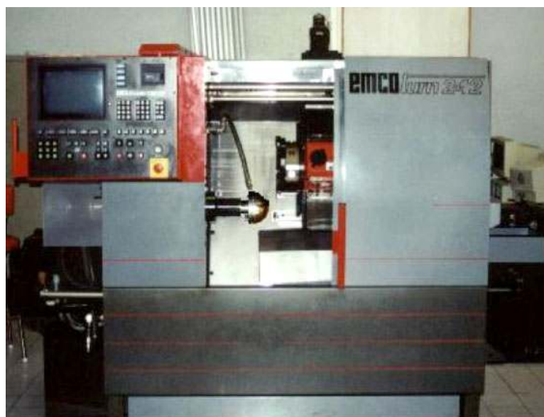
Figura 5.13. Máquina de control numérico EMCO TURN 242, utilizada para la manufactura de las piezas del cojinete neumático.
