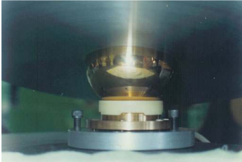
Figura 5.18. Cojinete neumático esférico terminado, donde se obtuvo por primera vez un medio sin fricción, con una carga máxima de 65 kg.
