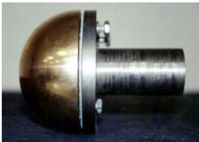
Figura 5.14. Herramienta utilizada para producir las piezas del cojinete neumático, en la máquina de control numérico EMCO TURN 242.
