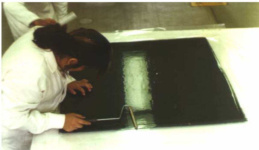
Figura 5.3. Una de las etapas de fabricación del panel de fibra de carbono-epoxy.
