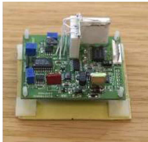
Figura 2.12. Brújula electrónica que consta de un magnetómetro en tres ejes y de dos inclinómetros en los ejes X,Y.
