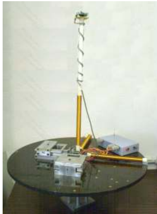
Figura 6.7. Conjunto de bobinas magnéticas en tres ejes, con el magnetómetro localizado sobre el eje Z, alejado de la influencia de los campos magnéticos producidos por estos actuadores.
