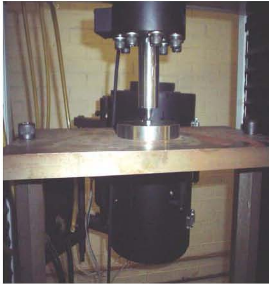
Figura 3.7. Dispositivo para la prueba de indentación
