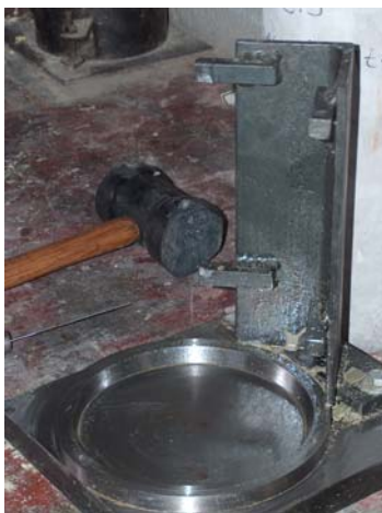
Fig.29. (Izquierda). Cabeceador de acero con respaldo y guía para asegurar la perpendicularidad entre el eje longitudinal y las caras de aplicación de carga. Mazo de neopreno para desmolde del espécimen una vez endurecido el mortero de cabeceo.
