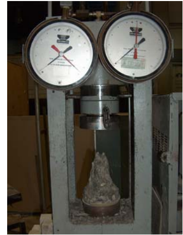
Fig.31. (Izquierda). Prensa hidráulica con capacidad de 120 toneladas, doble manómetro, motor eléctrico con regulador de velocidad de carga. El equipo cumple con lo especificado en la norma mexicana NMX-C-083-ONNCCE-2002.
