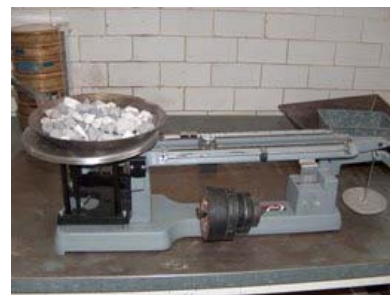
Fig.08 Pesado del retenido parcial de grava
