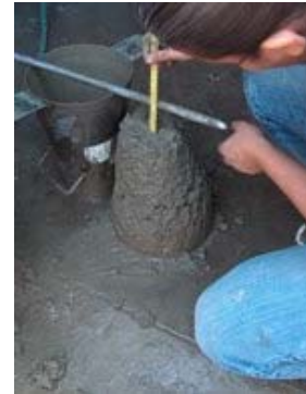
Fig. 21. Prueba de revenimiento
