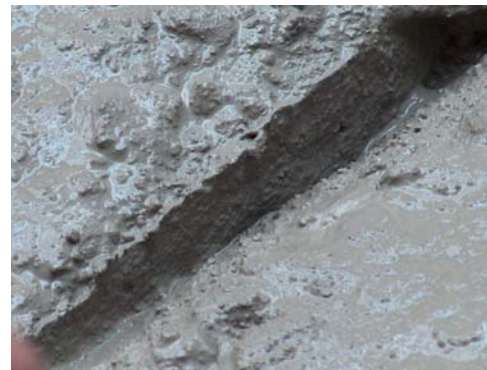
Fig.22. Verificación práctica del sangrado de la mezcla
