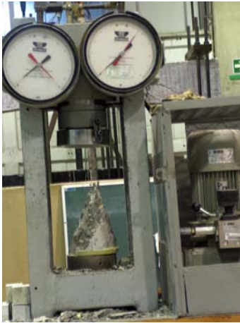
Fig.31. (Izquierda). Prensa hidráulica con capacidad de 120 toneladas, doble manómetro, motor eléctrico con regulador de velocidad de carga. El equipo cumple con lo especificado en la norma mexicana NMX-C-083-ONNCCE-2002.
