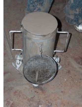
Fig.27. (Izquierda). Llenado de los moldes cilíndricos de 15x30 cm.
