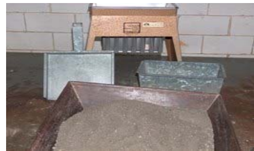
Fig.06 Reducción de la arena método A
