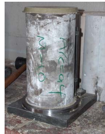
Fig.29. (Izquierda). Cabeceador de acero con respaldo y guía para asegurar la perpendicularidad entre el eje longitudinal y las caras de aplicación de carga. Mazo de neopreno para desmolde del espécimen una vez endurecido el mortero de cabeceo.
