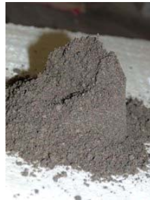
Figuras 17, 18 y 19 Determinación de la masa específica en estado saturado superficie seca
