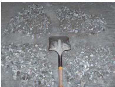
Fig.05 Reducción de la grava método B
