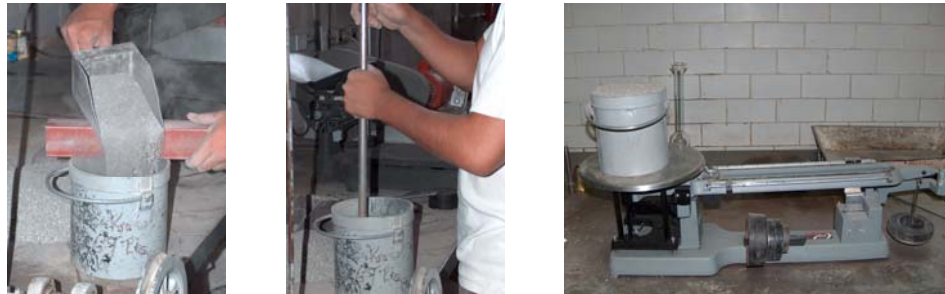
Figuras 09, 10 y 11 Determinación de la masa suelta y compacta del agregado fino (arena)
