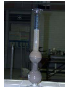
Figuras 17, 18 y 19 Determinación de la masa específica en estado saturado superficie seca
