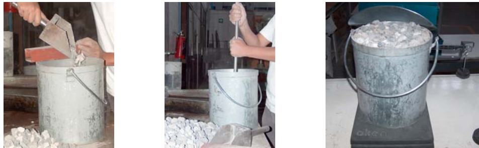
Figuras 12, 13 y 14 Determinación de la masa suelta y compacta del agregado grueso (grava)
