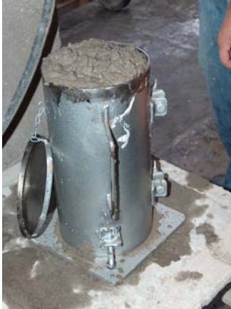
Fig.27. (Izquierda). Llenado de los moldes cilíndricos de 15x30 cm.
