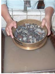
Fig.15 (izquierda) Cribado de la grava por la malla No.4 después de saturarse para llevarla a su estado saturado superficie seca.
