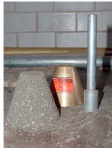
Figuras 17, 18 y 19 Determinación de la masa específica en estado saturado superficie seca
