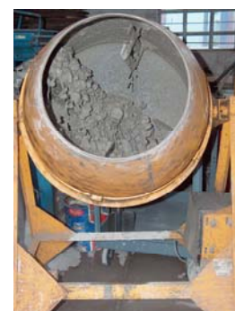
Fig.20. Mezclado del concreto
