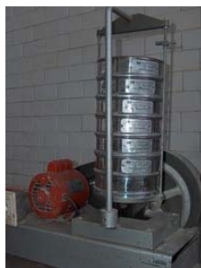
Fig.07 Cribado de arena
