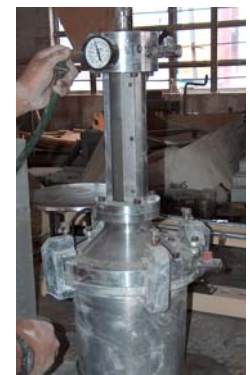
Fig.24. Determinación del volumen de aire atrapado en el concreto fresco.
