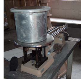
Fig.23. Determinación de la masa volumétrica del concreto fresco
