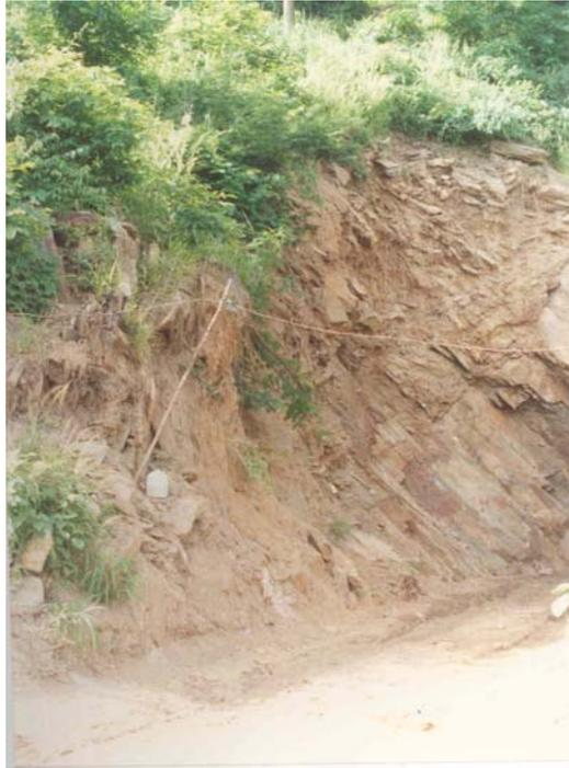
**Fig. 14 Ejemplo de foliación y fracturamiento**
