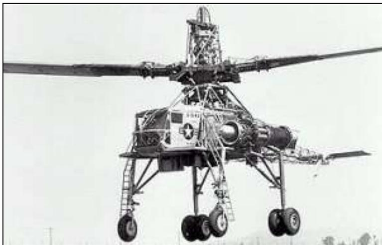
**HELICÓPTERO CAPAZ DE SOPORTAR UNA CARGA DE 25 TON. <sup>7</sup>**
