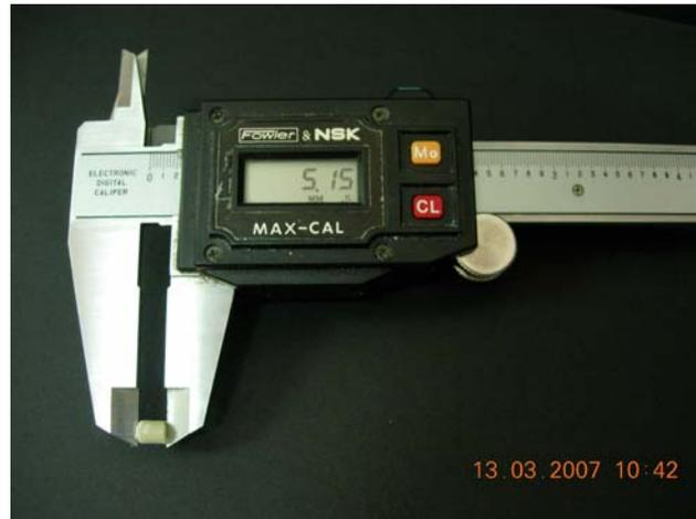
*Figura 2.* Medición de las muestras de profundidad de curado
