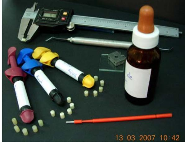
*Figura 1.* Material empleado en la prueba de profundidad de curado
