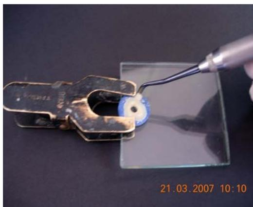
*Figura 16.* Colocación de la resina por bloque
