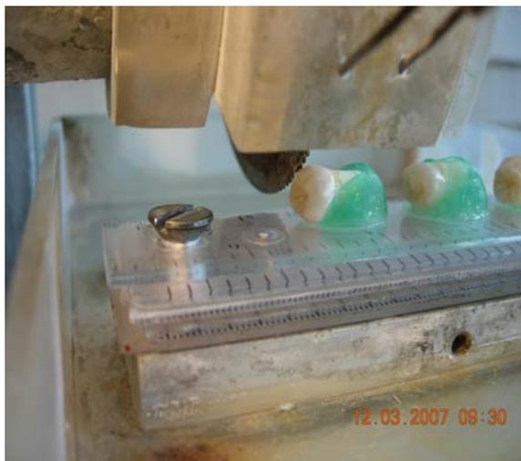
*Figura 7.* Corte de muestras para la prueba de resistencia al desalajo
