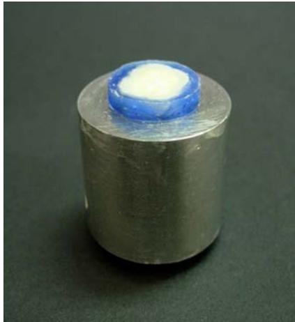
*Figura 9.* Montaje de muestras en hacedores cilíndricos
