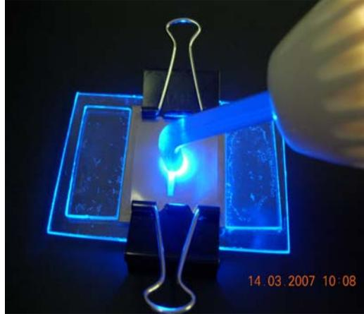
*Figura 21.* Fotopolimerización de las muestras para resistencia a la flexión
