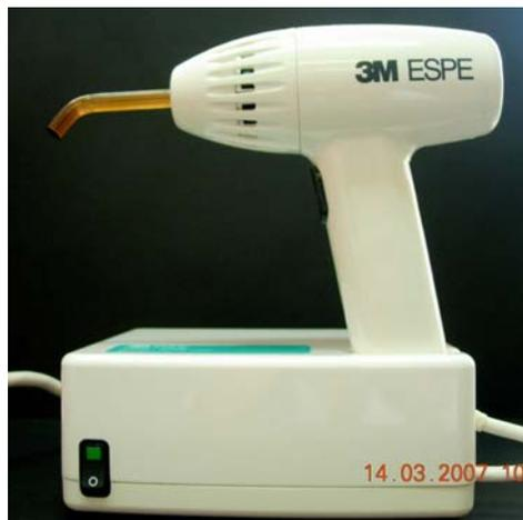
*Figura 6.* Equipo empleado para polimerización de muestras
