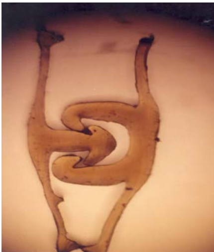
Fig.V.2.- Elemento resellable con cabeza asimétrica
