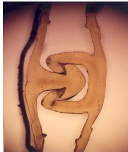
Fig.V.3.- Elemento resellable con cabeza simétrica.
