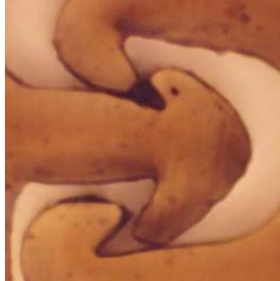
Fig.V.4 .- Zona de enganche del elemento resellable.
