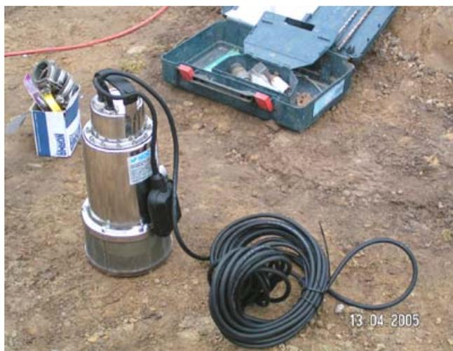
**Fig. 4.6:** Bomba de inmersión para heces fecales; activada por flotadores. (Foto propia)
