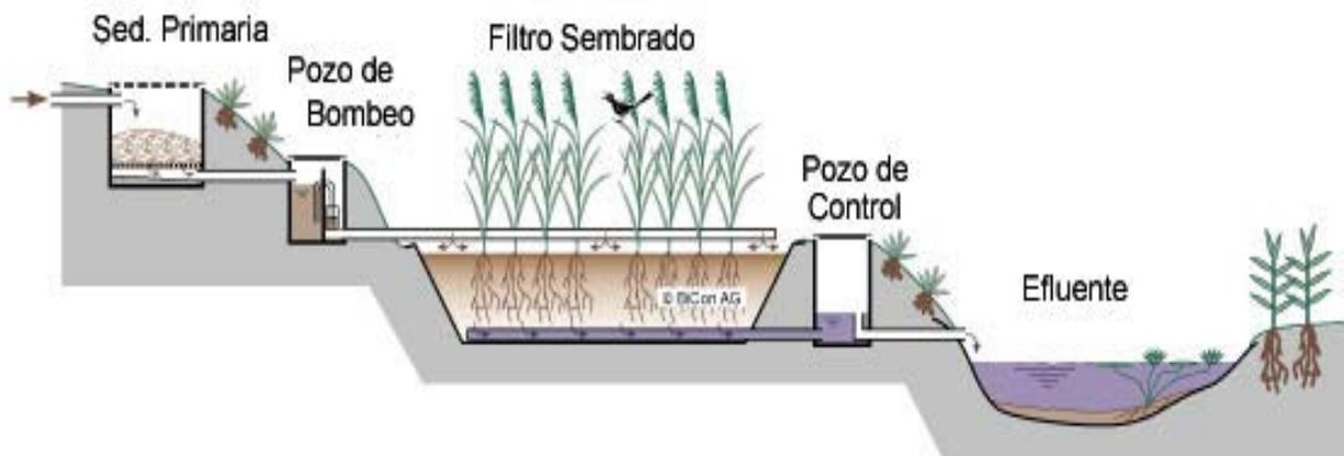
Fig. 4.2: Esquema general de una Pflanzenkläranlage (Pka)
