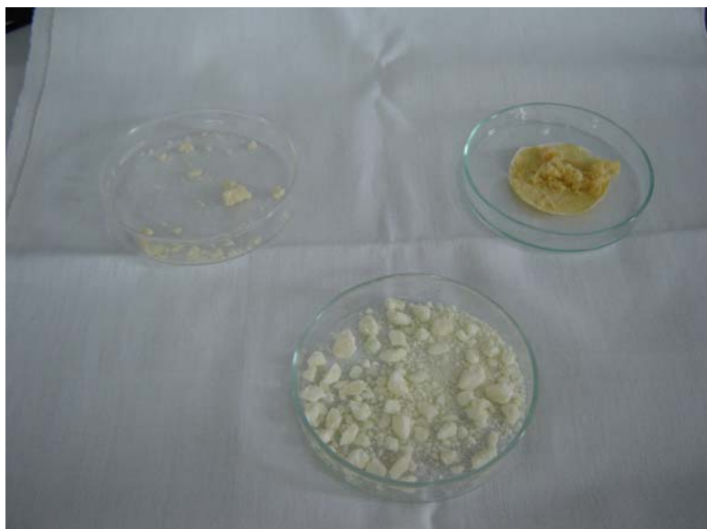
Figura 3.21 Poliésteres obtenidos en la metodología 2 purificados con peróxido de hidrógeno ( H_2O_2 ).
