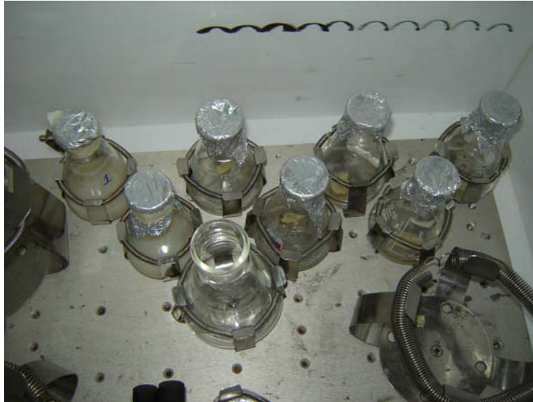
Figura 3.31 Matrices colocados en incubación a 37°C y agitación vigorosa.
