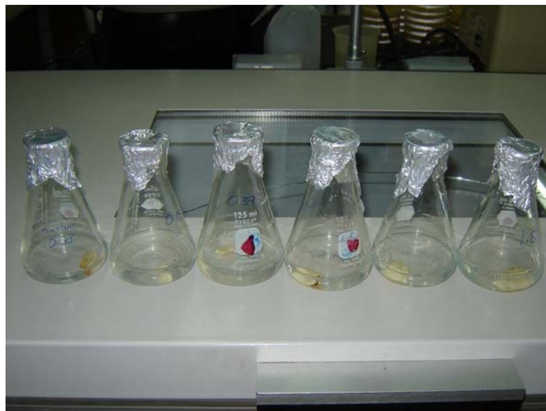
Figura 3.32 Matraces con el biofilm creciendo sobre la superficie del material a causa de la cepa bacteriana.
