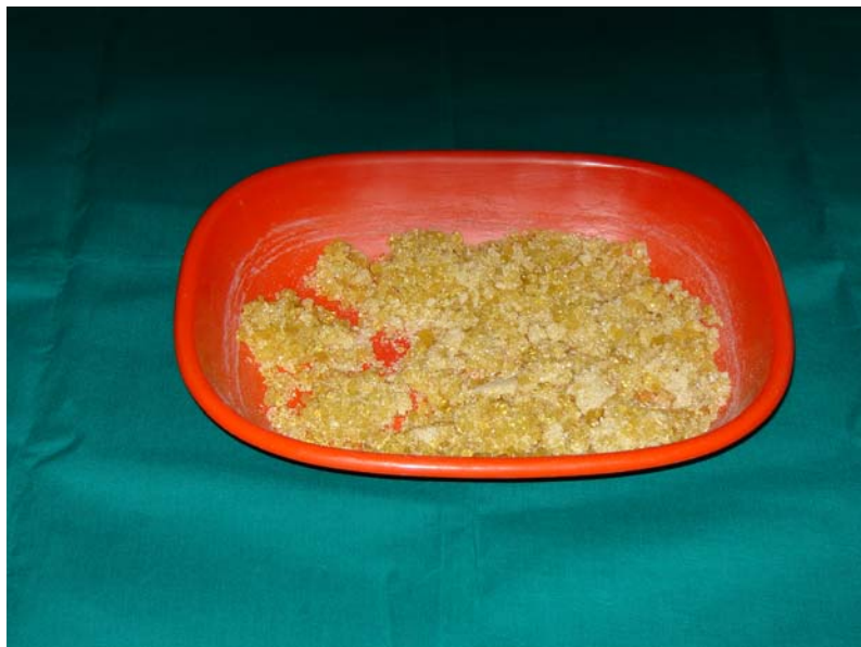
Figura 3.25 Poliéster obtenido en la metodología 3 purificado con peróxido de hidrógeno ( H_2O_2 ).
