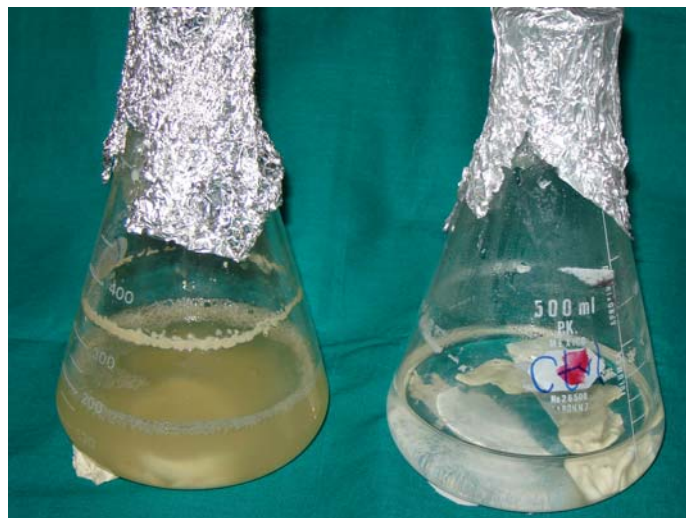
Figura 3.34 Cultivo con una concentración de poliéster de 3%, a la izquierda el matraz con la bacteria y a la derecha el matraz con el control, es decir, sin bacteria.
