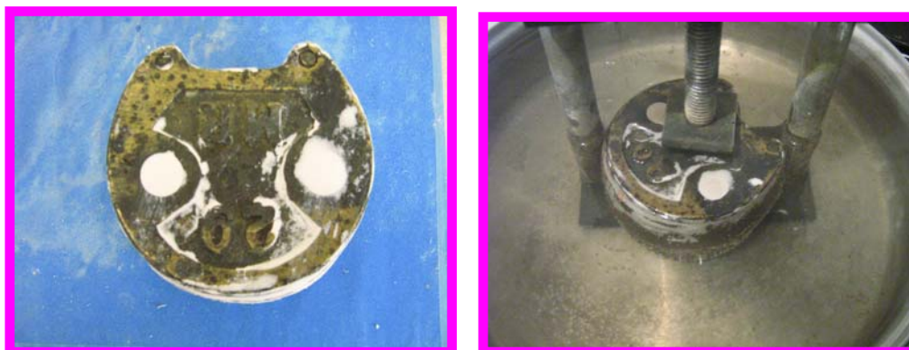
Fotografía 152 y 153. Se enmufla y se coloca en el horno para Desencerrar (Fuente directa)
