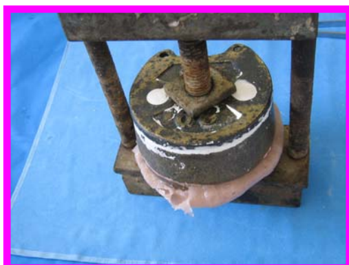
Fotografía 169. Se enmufla y se coloca en el horno durante 1 hora (Fuente directa)
