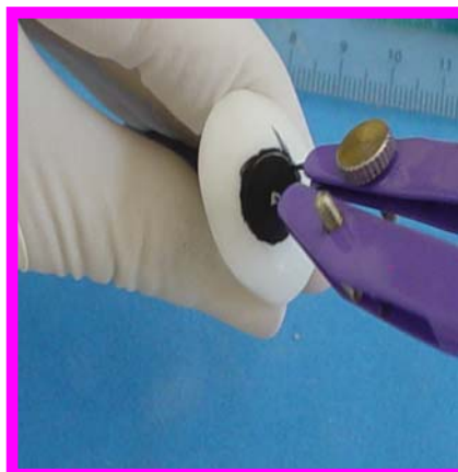
Fotografía 105 y 106. Se rectifican las medidas (9 mm)
