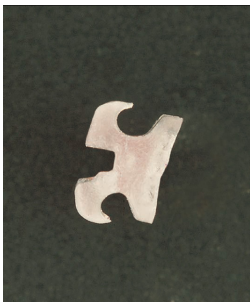
Fig.24 Bracket de plástico abierta. Obsérvese la deformación al aplicar un fuerza provoca su fractura.
