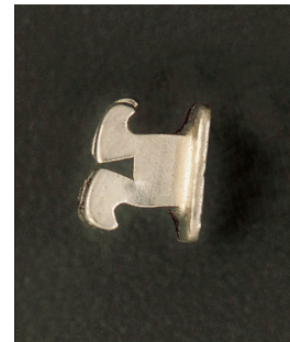
Bracket metálica abierta y cerrada. Deformación plástica provocada por un exceso de fuerza.
