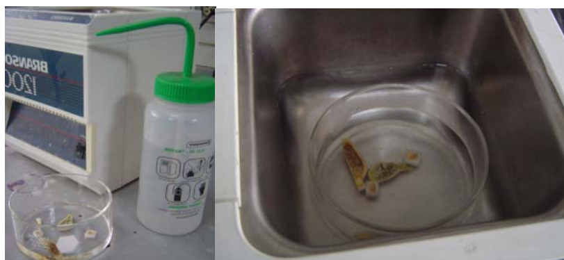
Fig. IV.9 Lavado ultrasónico de las muestras.
