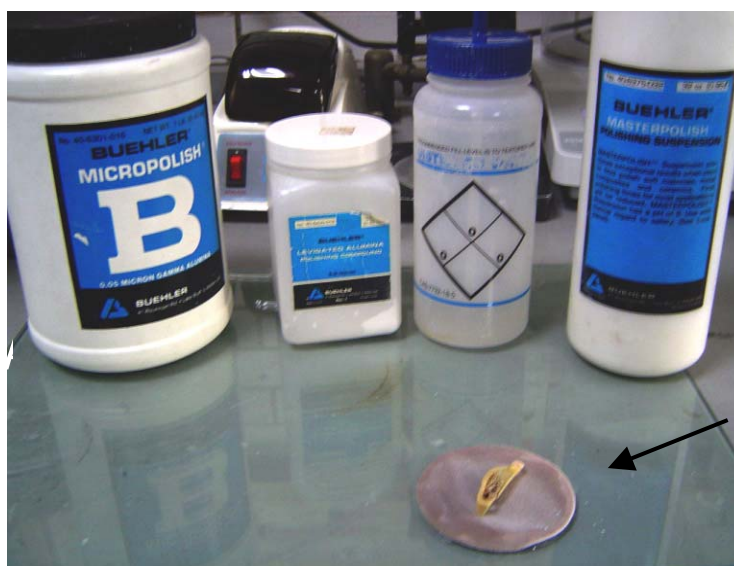
Fig. V.8 Pulido de la muestra con paño y alúmina. La flecha señala la muestra
