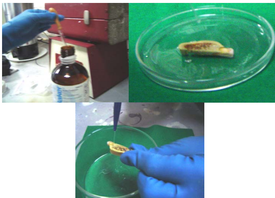
Fig. IV.10. Ataque químico y lavado de las muestras.
