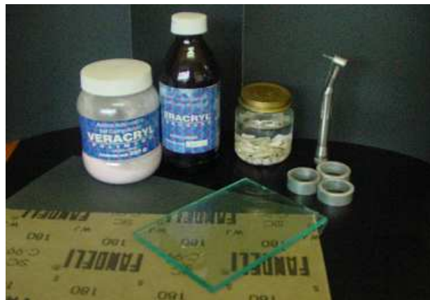
Fig. 1. Resina acrílica autopolimerizable Veracryl (zeyco) ® Dientes de bovino Pieza de alta velocidad, Fresa de bola de carburo, Loseta de vidrio Aros de aluminio de 1 pulgada. Hojas de carburo de silicio de grano 100 y 180
