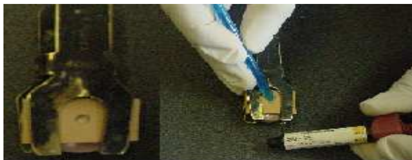
Fig.7 molde de teflón con perforación al centro sujetado. Colocación de resina en la perforación..
