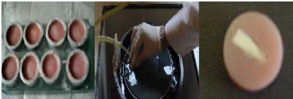
Fig.3 de izquierda a derecha, Dientes de bovino colocados en aros de aluminio y embebidos con resina acrílica. Pulidor metalográfico. Especimen con dentina expuesta
