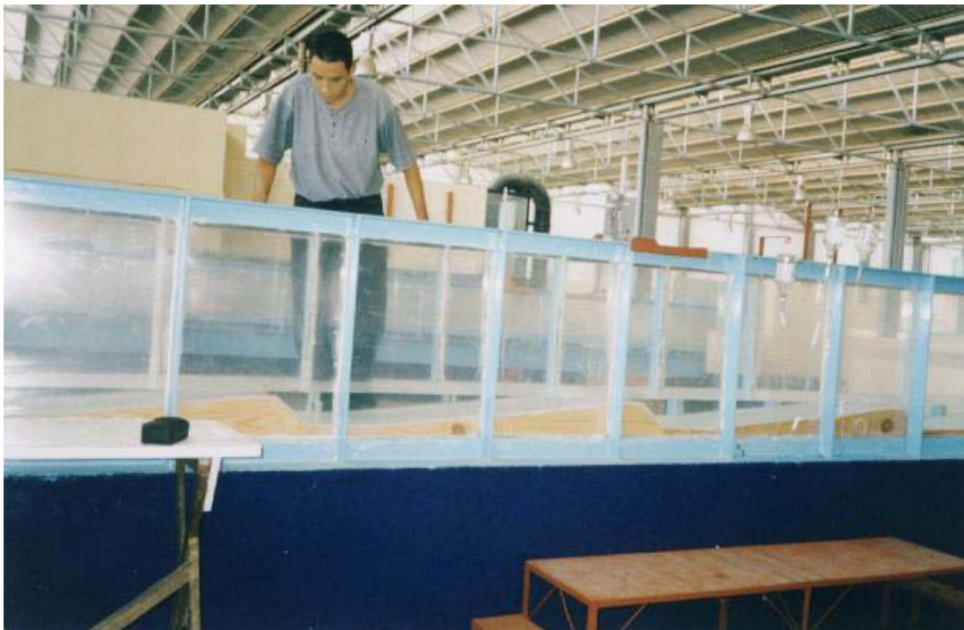
Figura II.1.2 b) Dunas sobre “tarrajas” se madera cubiertas con lámina de acrílico.
