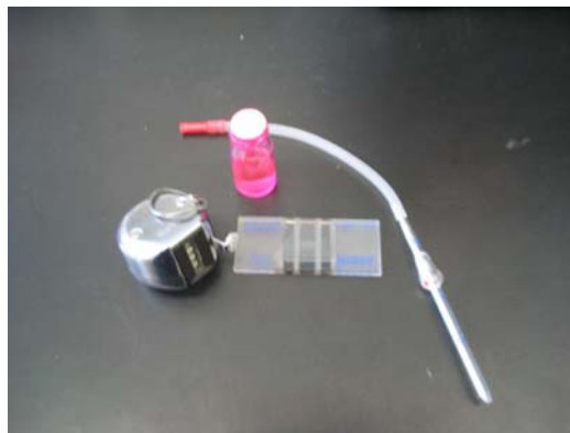
Figura 27. Material para evaluar la concentración del eyaculado. Contador, cámara de Neubauer, pipeta para glóbulos rojos, Fucsina.
