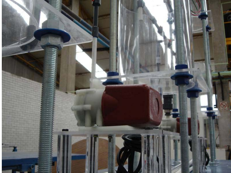
Figura. 36. Bombas fijas en Base.
