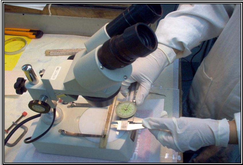
Figura 17.- Tratamiento de la Muestra. A) Secado de los núcleos en estufa; B) Traslado y rasado con navaja de acero inoxidable; C) Medición de anillos con Vernier (con una incertidumbre de 0.05 mm); D) Entrecruzado de núcleos
