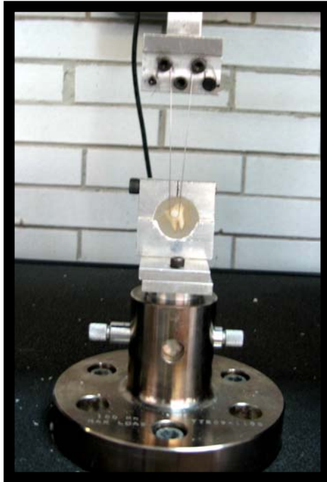
Fig. 8. Prueba de desalajo traccional con la maquina universal de pruebas Instron a 1mm por minuto.
