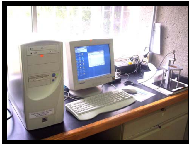
Fig. 1. Equipo para medir la contracción
