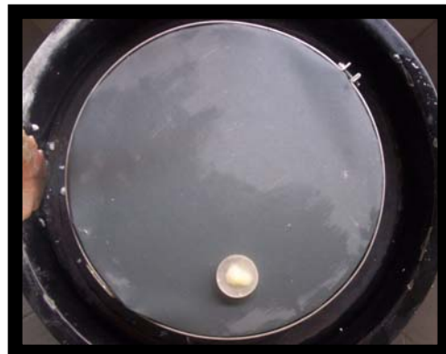
Fig. 2. Desgaste en el pulidor Metalográfico para exponer la dentina con papel de carburo de silicio de grano 100, 300, 600.
