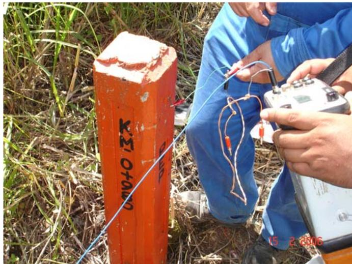
Figura 5.3 Medición de los voltajes en los postes de control de protección catódica.
