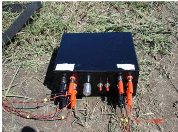
Figura 4.29 Fotografía del hardware de acondicionamiento.
