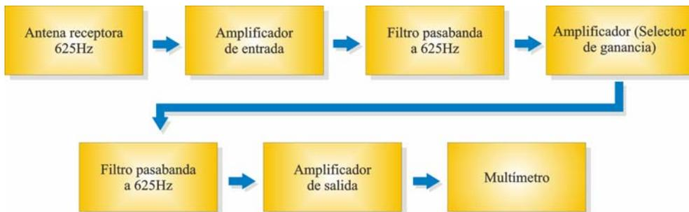
Figura 4.2. Diagrama a bloques del equipo receptor a 625Hz.
