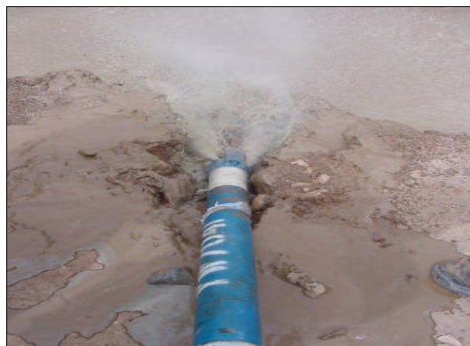
Inyección de prueba de fluido
