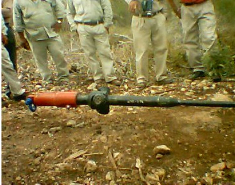
Retroensanchado simple en roca
