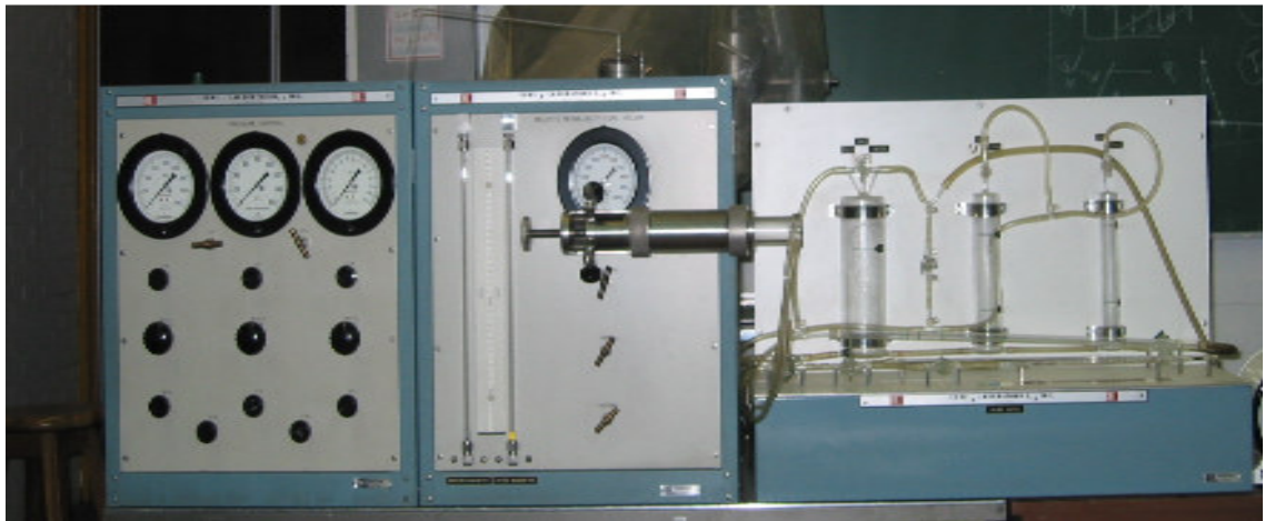
Figura II.9 Fotografía del equipo para desplazamientos de fluidos en régimen variable (4)
