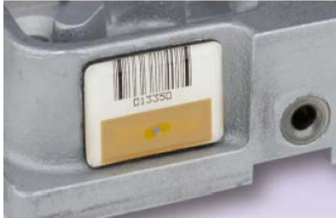
**Figura 4.11. Tag para metal de Schreiner LogiData<sup>16</sup>**
