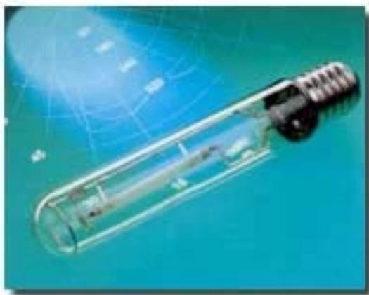
temperatura es considerablemente mayor ya que trabajan aproximadamente a 260°C para asegurar que el sodio se vaporice. El 90% de la radiación que se emite se encuentra en un rango de 589 a 589.6 nm. El pico de radiación monocromática es próximo al máximo de la curva de sensibilidad espectral del ojo colocándola en la más eficiente fuente de luz.
