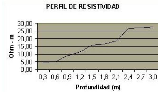
Capa superficial muy seca, capa inferior arenosa: perfil de resistividad descendente. Lugar: Zona urbana de Aguascalientes, Ags. Para simular su comportamiento se requiere de por lo menos utilizar los valores de 2 capas.
