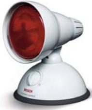
El filamento de Tungsteno trabaja a temperaturas de 2500 (°K) y emiten una longitud de onda de 760 a 1400 (nm). Su aplicación esta dirigida a aplicaciones industriales (polimerización, vulcanización, secado rápido, etc., o también para cocinas en hogares trabajando de 250 a 375 W si son convencionales y halógenas de 500 a 3000 W. Para la avicultura convencional, trabajan de 100 a 375 W mateadas, uniformizan el flujo y reducen la radiación visible.
