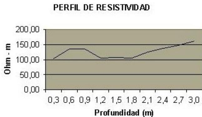
Existen programas para elaborar modelos del terreno con los datos de las mediciones. La figura de ejemplo es del programa *RESAP-Soil Resistivity Analysis* de la compañía Safe Engineering Services and Technologies Ltd.
