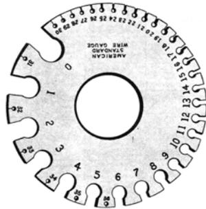
El conductor se calibra en su parte interior, no en su parte exterior
