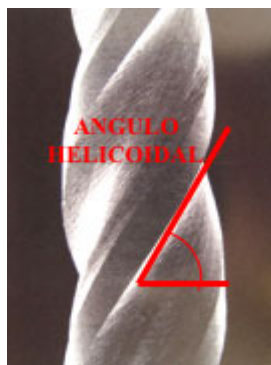
Fig. 3 Ángulo helicoidal. LEONARDO, M.R., De Toledo, R. Sistemas Rotatorios en Endodoncia: instrumentos de níquel-titanio. 2002 Editorial Artes Médicas.
