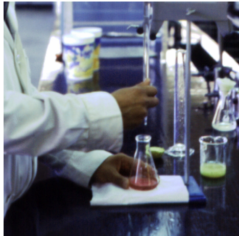
Figura. 12. Determinación de la acidez en la muestra de Guavaba.
