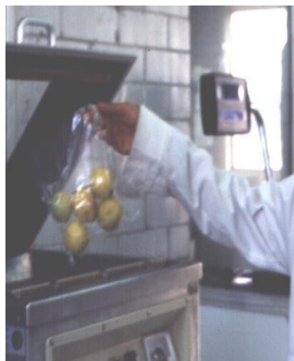
Figura 1018. Envasado de guayaba en atmósfera modificada.
