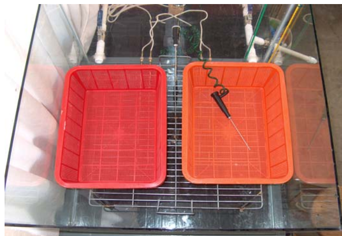
Figura 4. Contenedores de la cámara de vapor.
