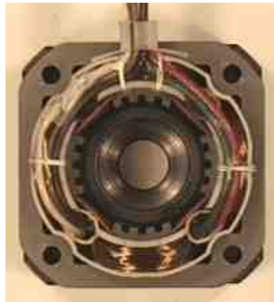
Figura 3.10 Estator de un motor a pasos de 4 bobinas [32]
