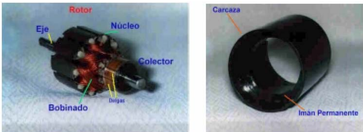
Figura 3.1 Rotor y estator de un motor de corriente continua [23]
