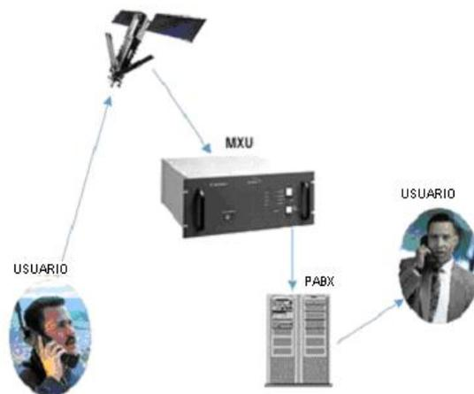
**Fig. 4.3 Función del Mobile Exchange Unit MXU en el Sistema Iridium.**
