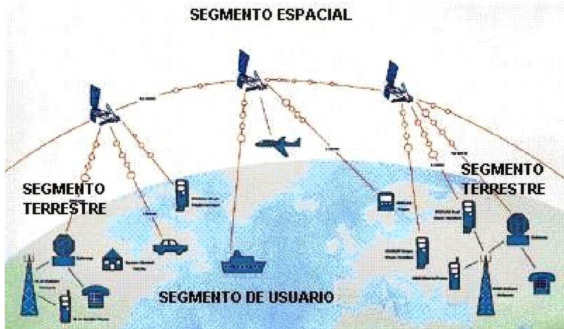
*Fig. 3.2 Segmentos del sistema Iridium.*
