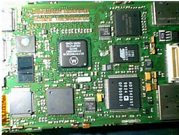
**Fig. 4.6 Vista de una porción de la tarjeta principal. Es el área principal del proceso en el teléfono.**
