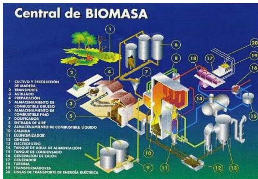
Figura 6.7 Central biomasa quema combustible tipo orgánico para producir vapor de agua, el cual mueve una turbina que es conectada a un generador, produciendo electricidad. Imagen: Wanadoo.
