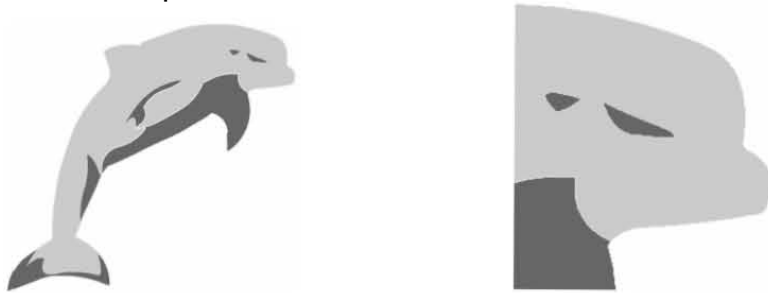
Figura 1 un gráfico en bitmap pierde resolución al ampliarlo o reducirlo.
