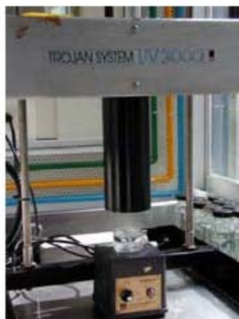
Figura 3.5. Equipo empleado para la desinfección con luz UV.
