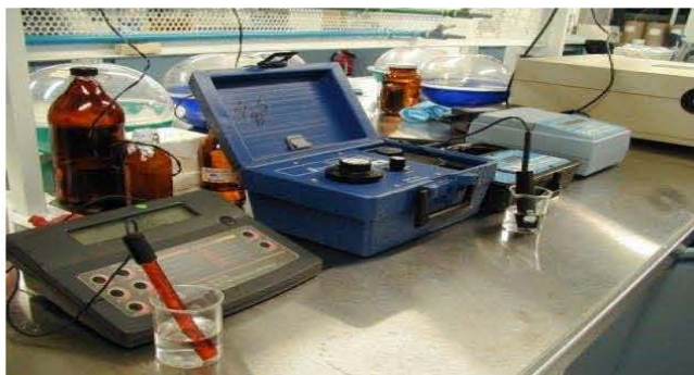
Figura 3.2. Equipo empleado para la medición de pH, turbiedad, conductividad, SDT, bromo, \text{NH}_3\text{-N} , absorbancia y transmitancia UV.
